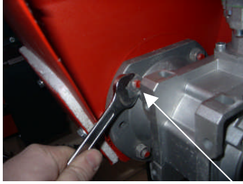
Afmontering af gear og snegl. Brug et stk. 17 mm fast / top nøgle
